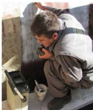
a) Prikaz UT ispitivanje ZS b) Lokacija jedne od površinskih prslina dubine 2,5 mm u sučeonom ZS Sl.7. Prikaz ispitivanja UT dubina površinskih prslina u jednoj zoni ZS sa spoljašnje strane cevovoda
