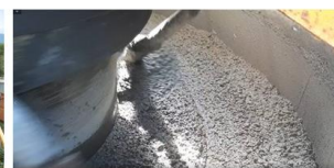
Slika 20. Fabrika betona, doziranje Sika Aer Solid, mešalica za beton, mešanje betona.
