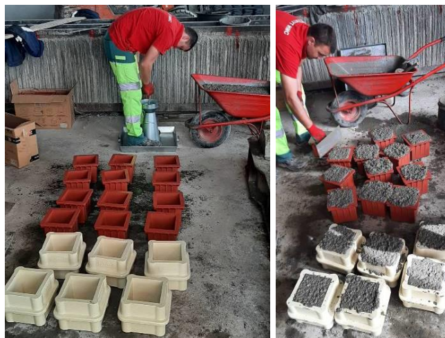
Slika 3. Provera konzistencije metodom sleganja (levo).
