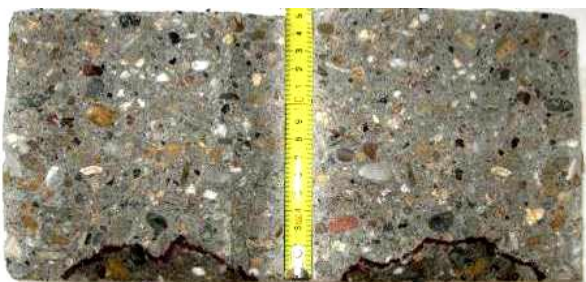
Slika 11. Merenje najveće dubine penetracije vode u beton.
