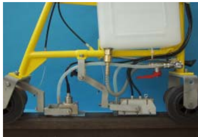
Slika 6. (gore) SPG 2 – Ovešanje sonde sa normalnim i sa snopom pod uglom.
