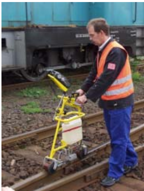
Slika 7. (levo) Ispitivač šina SPG 2 sa ultrazvučnim detektorom USM25.
