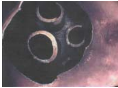
Sl. 9: Višestruki lom cevi zagrejača napojne vode visokog pritiska, registrovan videoskopom kroz otvor na cevnom nosaču i oštećenu cev
