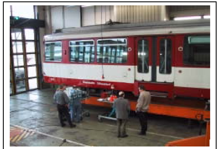
Slika 15. Ispitivanje zglobnog voza sa 4 nosača ispod vagona ( osam pari točkova ).
