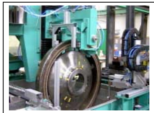
Slika 5. Ispitivanje novih monoblok točkova.
