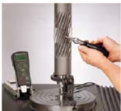
Slika 3. Ispitivanje tvrdoće pomoću UCI instrumenta (MIC 10) na zupčaniku pogonskog vratila.
