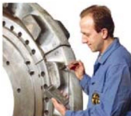
Slika 4. Ispitivanje tvrdoće pomoću odskočnog merača (DynaMIC) na pogonskom točku hidrauličkog ekskavatora).
