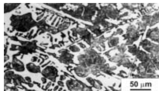
Slika 8. Mikrostruktura radne površine plašta 6
