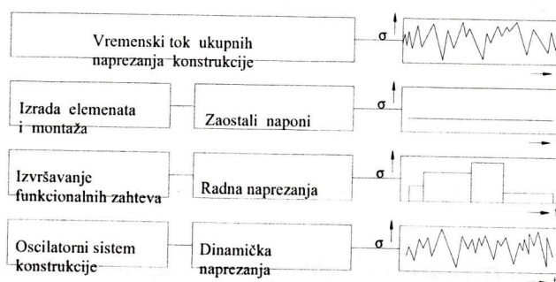
Slika 1. Prikaz rasčlanjenog ukupnog naprezanja prema uzroku nastanka
