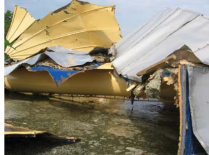
б) Лом резервоара због пада водоторња
