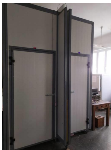
Slika 1. Ispitna komora za određivanje koeficijenta prolaženja toplote.
