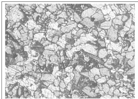
Slika 3.1: Pozicija 1 - osnovni materijal (beinit, ferit, perlit) Figure 3.1: Position 1 - base metal (bainite, ferrite, pearlite)
