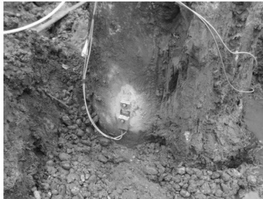
Slika 13. Senzor za merenje deformacije i ubrzanja šipa
