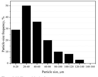
Figure 4: Mullite-particle size frequency Slika 4: Velikostna razporeditev mulitnih zrn
