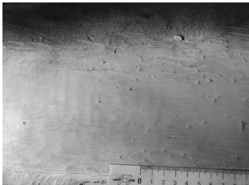
a) Prikaz površinske prsline u ZUT
