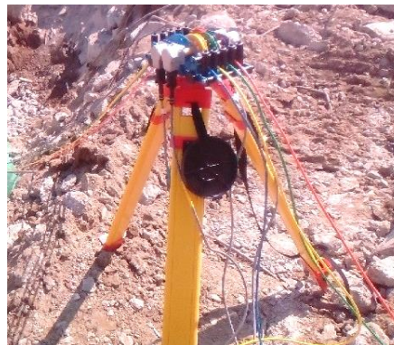
Slika 11. CHAMP-Q oprema za ispitivanje integriteta šipova testom integriteta šipa sa sondama (CSL) američke firme Pile Dynamics [14]
