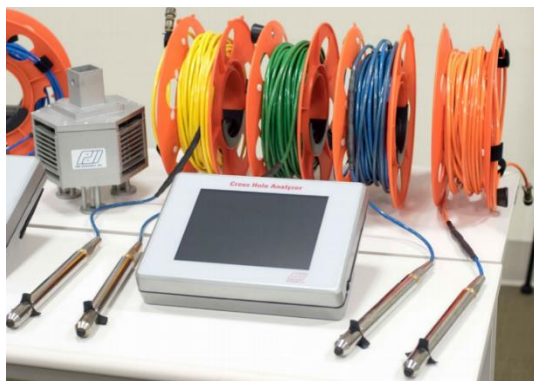
Slika 11. CHAMP-Q oprema za ispitivanje integriteta šipova testom integriteta šipa sa sondama (CSL) američke firme Pile Dynamics [14]
