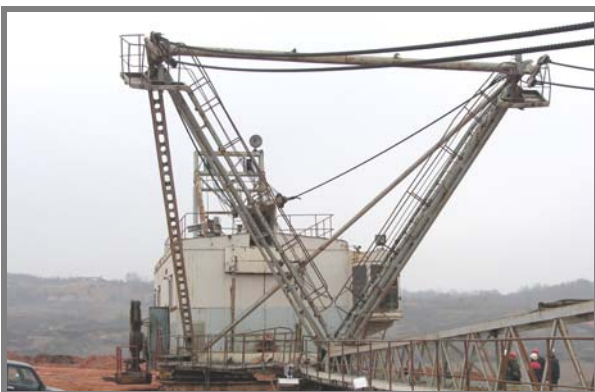
Slika 1a: Bager dreglajn EŠ 5/45, prednja strana
