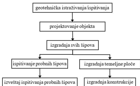
Slika 2. Dijagram toka metodologije ispitivanja šipova – uobičajena inženjerska praksa – var. 2
