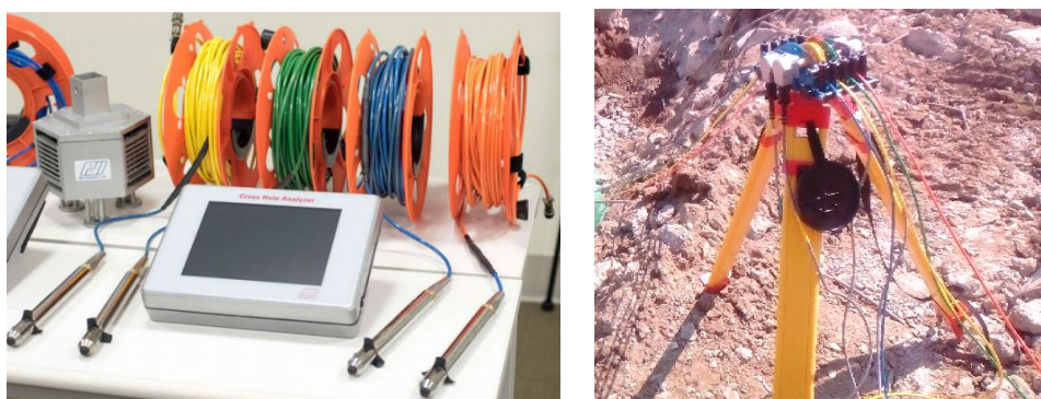
Slika 9. CHAMP-Q oprema za ispitivanje integriteta šipova testom integriteta šipa sa sondama (CSL) američke firme Pile Dynamics [15]
