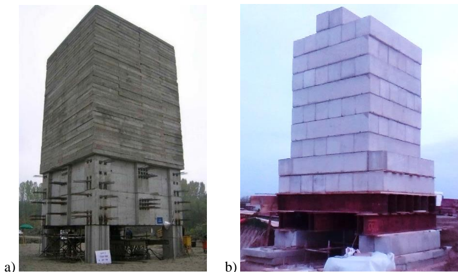
Slika 4. Test statičkog opterećenja šipa (SLT) - kontrateret: a) most Mihajla Pupina u Zemun-Borči u Srbiji (kontrateret formiran od armiranobetonskih ploča), b) vetropark Malbunar u Srbiji (kontrateret formiran od armiranobetonskih blokova) [7]
