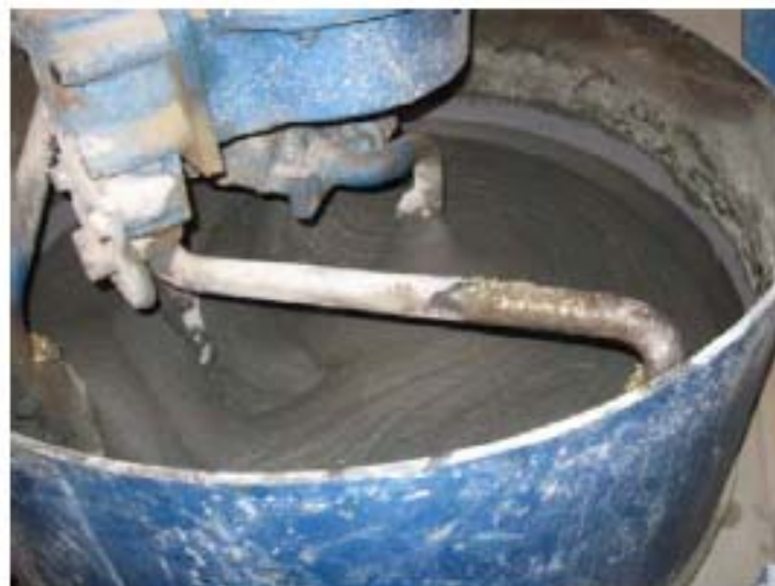
Слика 6.7 - Мешање бетона веома високих чврстоћа на Schlosser мешалици
