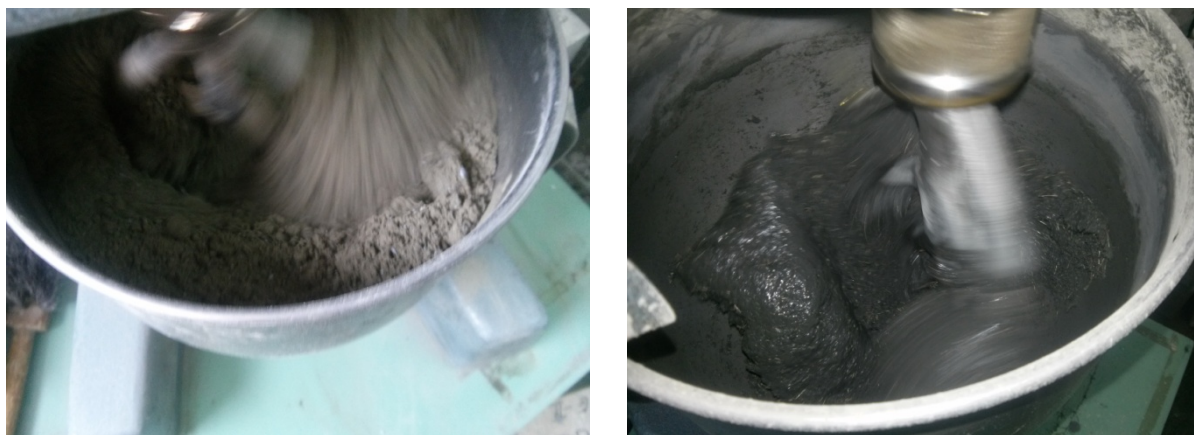
Слика 6.6 - Мешање бетона у мешалици за цемент лево: након додате воде, десно: након додавања влакана - микроарматуре
