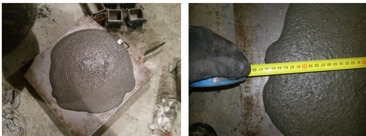
Слика 6.9 - Мерење конзистенције методом распростирања слегањем бетона
