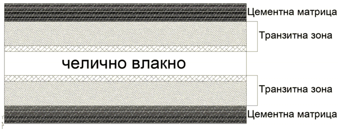
Слика 2.12б - Шема транзитне зоне између влакна и цементне матрице
