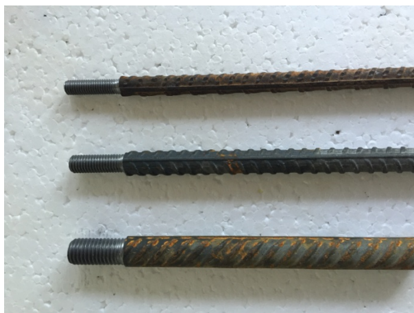
Слика 6.5 - Анкери припремљени за уградњу у бетон
