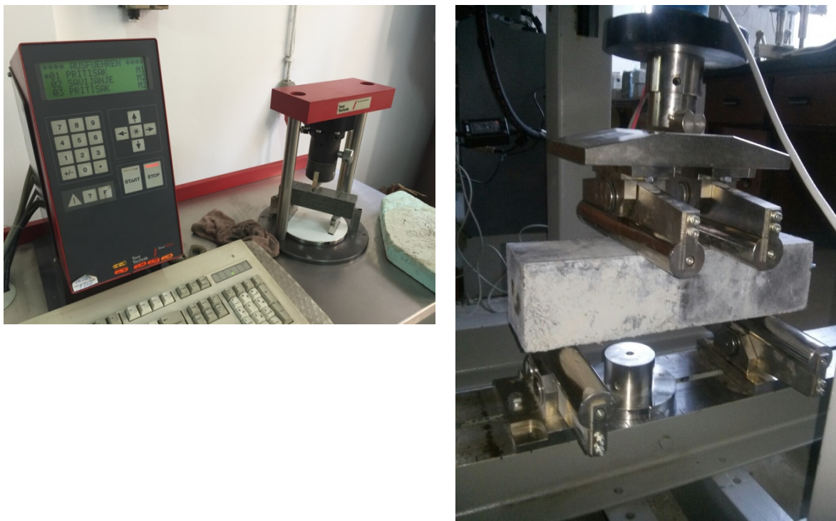
Слика 6.12 - Одређивање чврстоће бетона при затезању савијањем
