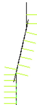
Figure 4. Contact elements and normals on contact elements Slika 4. Kontaktni elementi i normale kontaktnih elemenata
