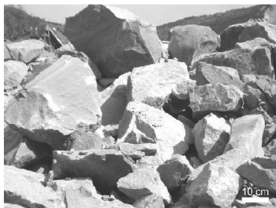
Slika 6 - Nepravilni oblici prirodnih i miniranih blokova stenske mase (Kamenica).
