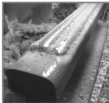
Slika 4: Izgled navarenih slojeva u više prolaza Figure 4: Repair welded rail by multipass welding
