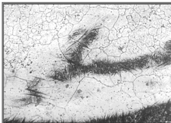
Slika 6: Karakteristični oblici pojave grubog zrna u Č7680 do spoja sa Č1730; kaljeno (trostepeno predgrevanje) sa 1473 K u rastopu soli na 833 K; 500x
