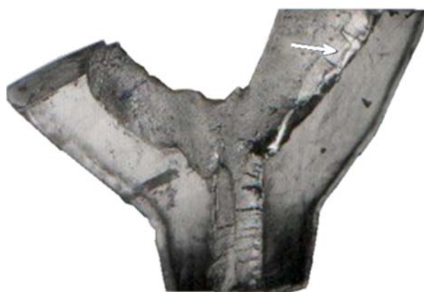
Slika 11. Površina preloma prirubnice nosača satelita sa naznačenim pojasom niskocikličnog zamora Figure 11. Fracture surface of satellite support fitting with indicated zone of low-cycle fatigue.
