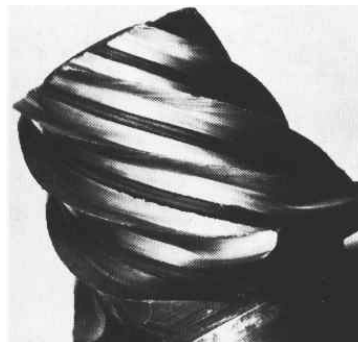
Slika 2. Prekomerno habanje Figure 2. Excessive wear.
