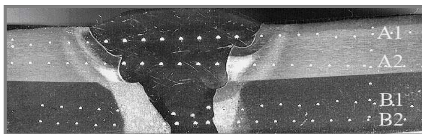
Slika 2: Raspodela tvrdoća HV1 kroz zavareni spoj dvoslojnog čelika
